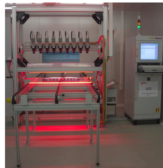
Проверка качества стекла (AOI)
